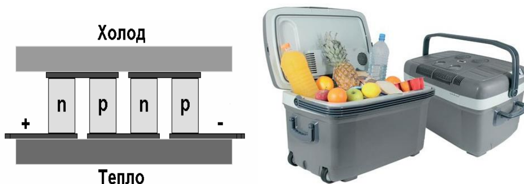
Рис. 52. Применение элементов Пельтье
